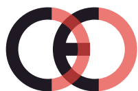
Falsk CE-mærke (for tæt på hinanden)
